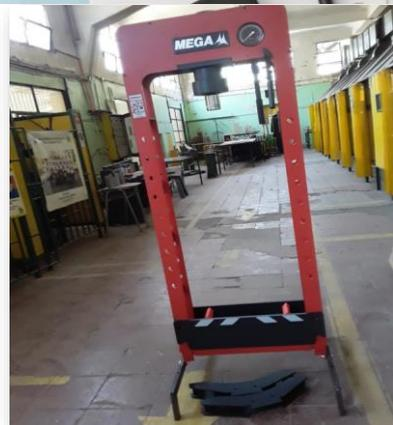
Prensa hidráulica 50 ton. columna
