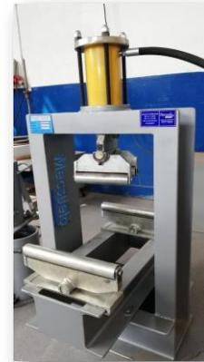
Prensa de Flexotracción Hidráulica,
